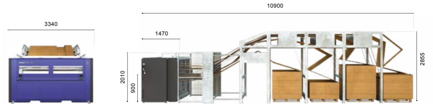
Layoutbeispiel: Compact mit automatischem Einzugsystem
